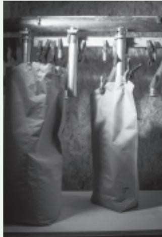
entschieden, welches einen Mühlstein von einem Meter Durchmesser hat. Damit können wir 30 kg Getreide von höchstehender Qualität pro Stunde mahlen. Das ist ziemlich langsam für eine Mühle. Zum Vergleich, ein industrieller Mühlenbetrieb produziert an einem Tag soviel Mehl wie wir in einem Jahr.
