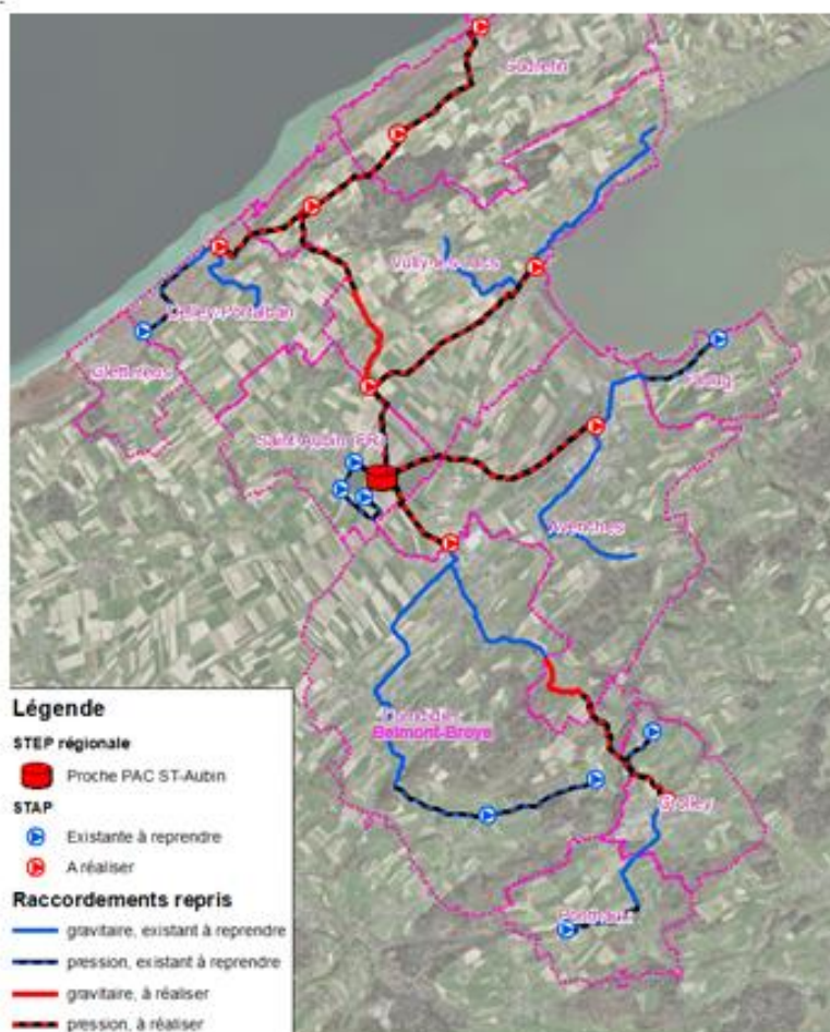
Figure 3 : Réseaux de raccordements à la STEP régionale EBBV
